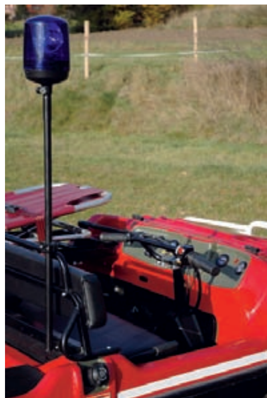
Abb. 2: Das Blaulicht dieses Prototyps ist einfach gehalten; auch andere Anbringungen der Sondersignalanlage sind möglich, z.B. auf einem Bügel
