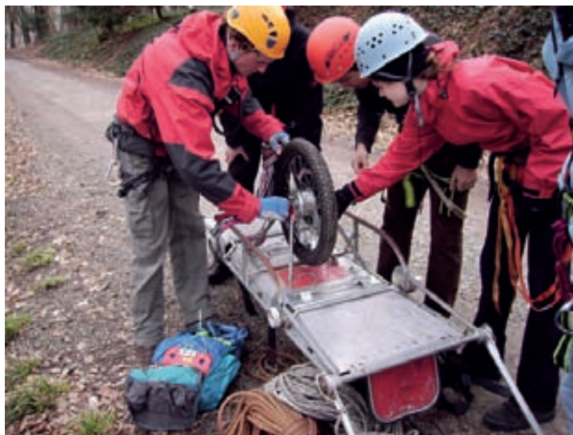
Abb. 2: Anbringen des Radsatzes an eine Gebirgstrage
